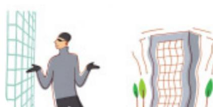
ガラスブロックが強風や地震のような強い衝撃に耐えられるのは、目地部分にステンレス製の筋を入れていることと、周囲の壁との間にクッション材を入れているから。またガラスブロックは分厚いガラスが2層になっているので、割ろうとしても大変な時間と労力を要します。防犯対策に効果的です。
