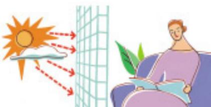
ガラスブロックの最大の魅力は、光を透す壁を実現すること。パターンによって視線をコントロールできるため、使用箇所に応じて選べます。また、ガラスブロックの目地がルーバーの役割をし、窓ガラスのように直接的に採光するのではなく、やわらかな拡散光で室内を均一に満たします。
