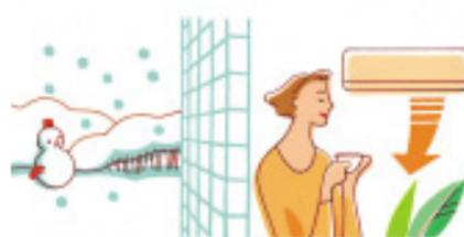
ガラスブロックは内部がほぼ真空のため、冬場はエアコンで暖まった室内の空気を外に逃げにくくし、夏場は冷えた室内の気温を保つ、省エネルギーに役立つ建材です。また熱線反射ガラスブロックは、太陽の熱線を反射・吸収によって約3分の1カットする省エネ効果の高いガラスブロックです。
