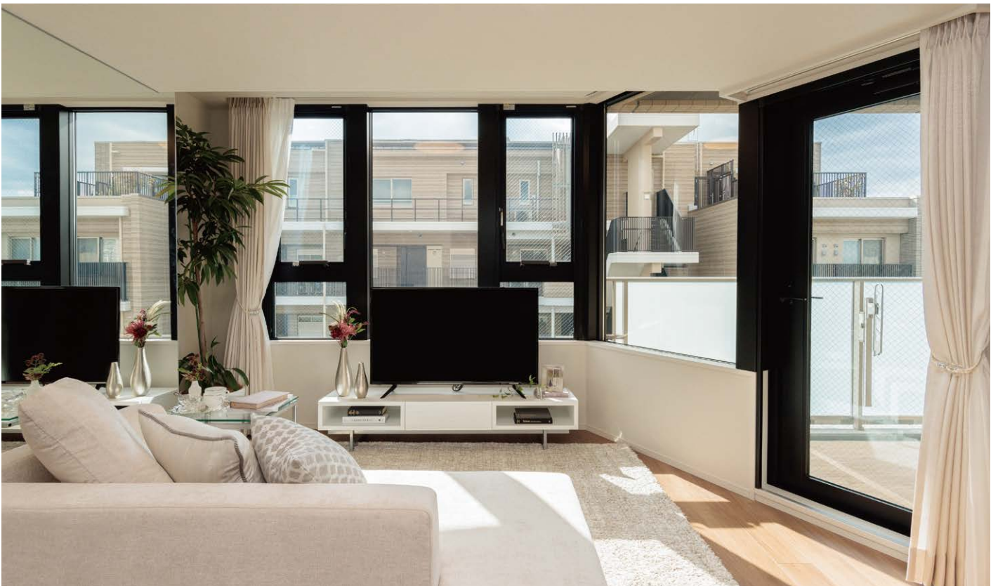
建物名称/パークホームズ甲子園四番町（兵庫） 施主/三井不動産レジデンシャル 設計・施工/村中建設 ※FIX窓がファイアライト入り防火設備です。
