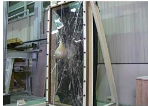
鋼球落下試験 (鋼球 1,040g/落下高さ 120cm)
