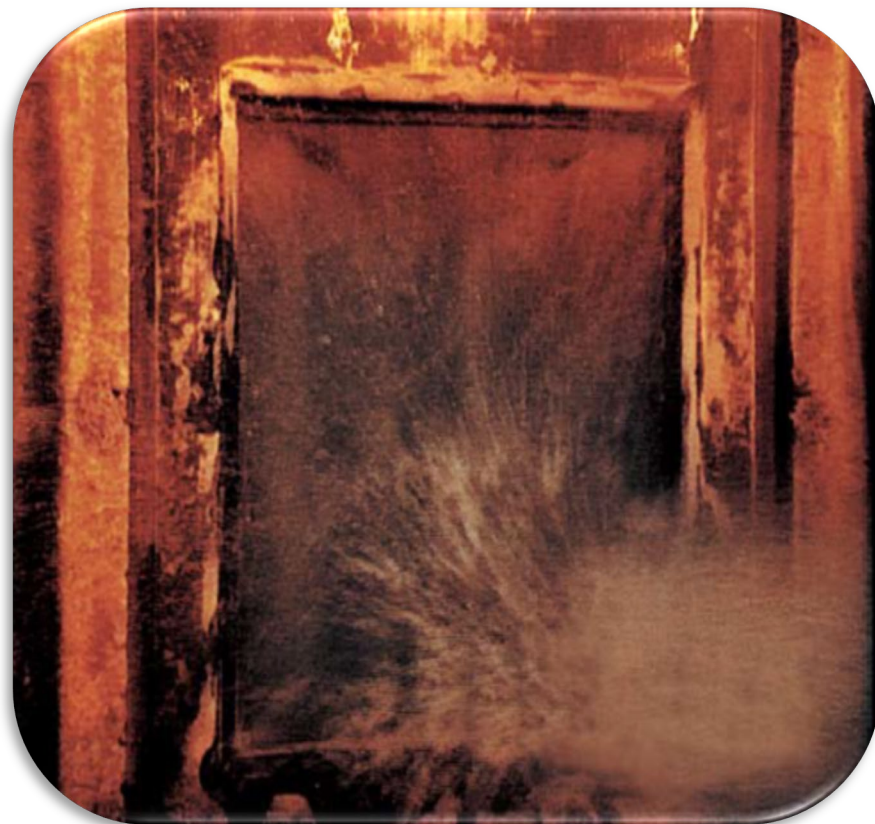
加熱後の放水状況 放水圧力30psi(207kPa)
