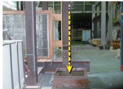
鋼球落下試験 (鋼球 1,040g/落下高さ 120cm)
