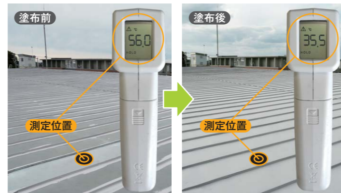
※外気温32~34℃、湿度21%で表面温度差20.5℃(時間帯、外気温の近い日を選んで測定)
