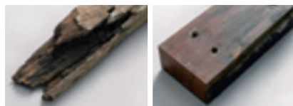
10数年使用して朽ち果てた木製の枕木(左)と、30数年使用してもほとんど変化のないガラス長繊維強化プラスチック発泡体の枕木(右)。
