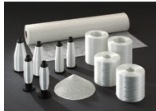
奥から時計回りに：チョップドストランドマット、ロービング、チョップドストランド、ヤーン
