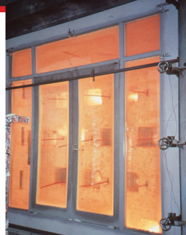
60分間の遮炎性能が求められる特定防火設備認定試験の様子。
