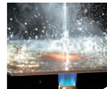
■熱衝撃に強いファイアライト®。800℃に熱した後に冷水をかけても割れず、火災の被害を最小限に食い止めます。
