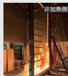
非加熱側 非加熱側ガラス面には水膜
