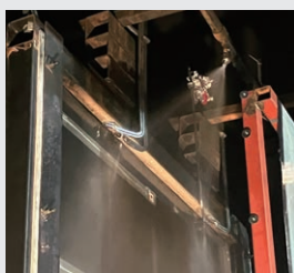
ドレンチャー設備を用いて水膜流を形成
