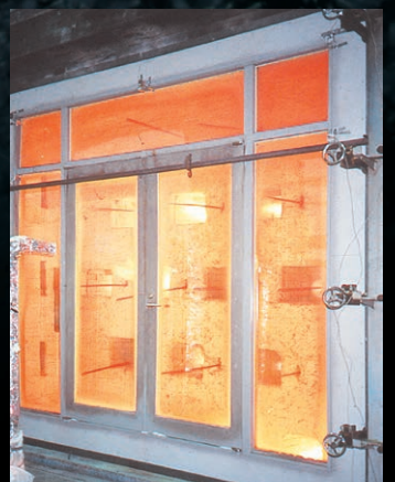
60分間の特定防火設備認定試験
