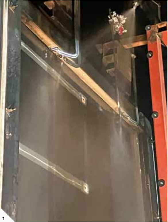
1／裏面側。ドレンチャー設備を用いて水膜流を形成する。 2／火災科学研究中心実験棟での試験の様子。
