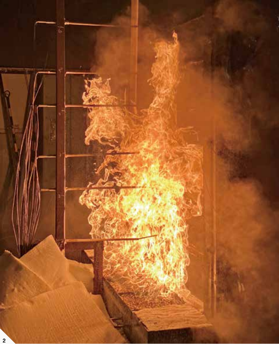
1／裏面側。ドレンチャー設備を用いて水膜流を形成する。 2／火災科学研究中心実験棟での試験の様子。
