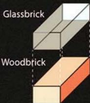
主構造兼外装材として等しい寸法を持つ形状のガラスブリックおよび木レンガを用い、特殊な接着剤と緊結材にて固定する。基本は組石造であり、現地住民が日干し煉瓦で慣れ親しんでいる工法のため、最低限の訓練で子供も含め自力施工が可能である。また、両レンガの組み方のパターンはランダムで自由度が高く住民自らが設計者にもなる。
